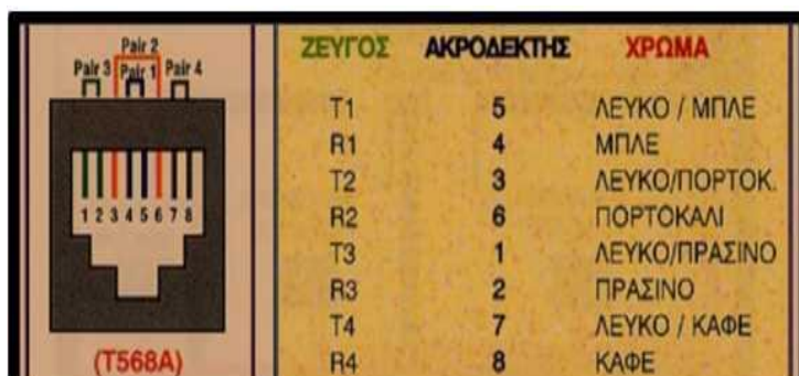
Σχήμα 10.4: Πρότυπο T568A Δομημένης Καλωδίωσης
